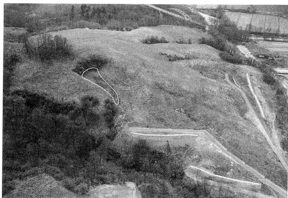
第4図 アースフロー観測地のななめ空中写真 白線で囲まれた部分は調査対象のアースフロー。 Fig. 4 Aerial oblique photo of Inasato earthflow. The earthflow is illustrated by white line.
