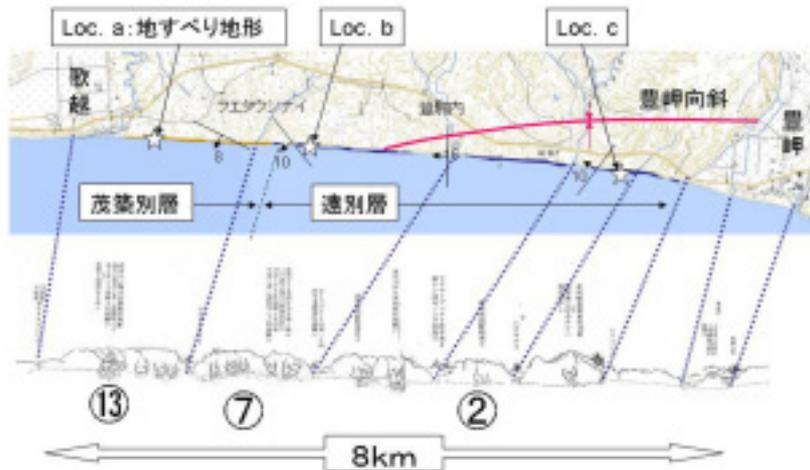
第3図 海食崖の地形・地質と山崩れの絵図 (東京大学地震研究所編, 1989)との対応. 海食崖の地質は秦 (1961) による.
