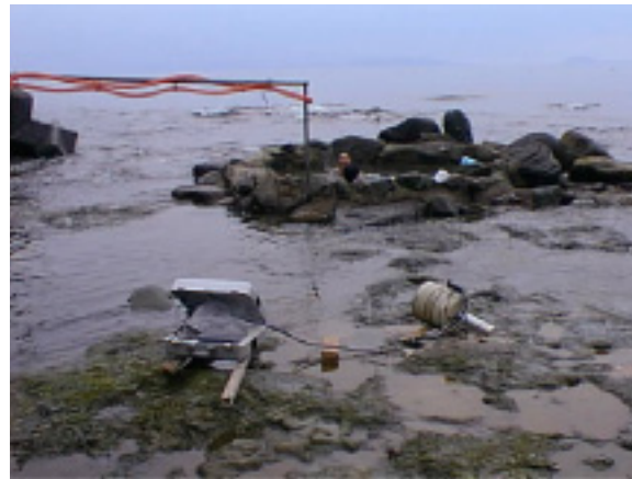
写真4 Ge半導体検出器を用いたMCAでの測定状況 (瀬石温泉) Photo 4 Measurement situation of the MCA used Ge semiconductor detector(Seseki hot spring).
