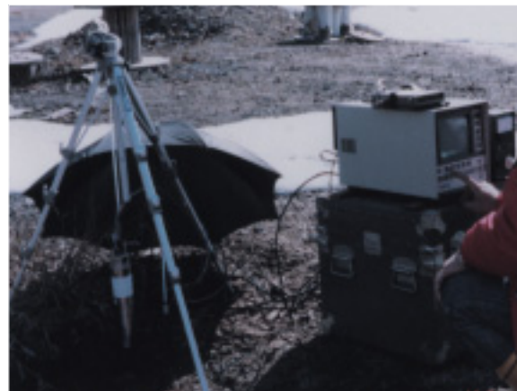
写真5 NaI(Tl)検出器を用いたMCAでの測定状況 (千走温泉) Photo 5 Measurement situation of the MCA used NaI(Tl) detector(Chihase hot spring).
