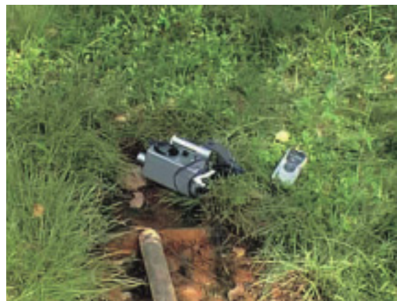
写真6 NaI(Tl)線量率計による測定状況 (雄阿寒温泉) Photo 6 Measurement situation used NaI(Tl) dosimeter(Oakan hot spring).
