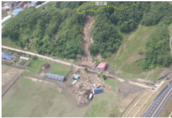
第4図 日高町平賀 (Loc.1) で発生した斜面崩壊のななめ空中写真 (株シン技術コンサル8月20日撮影)。中央下部の青い屋根が倒壊した家屋。矢印は家屋の移動量を示す。
