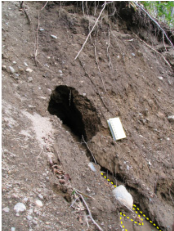
第15図 斜面崩壊頭部に出現したパイピングホール (径40cm). 破線の下は岩盤, 上は斜面堆積物 Fig. 15 Piping hole at the top of the landslide.
