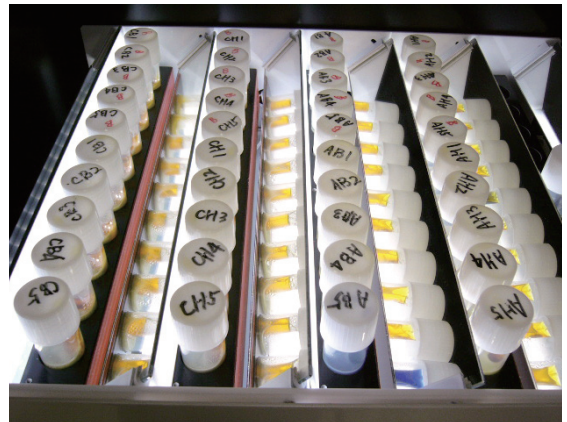
図2-2. Biomatic™VDCSにて 培養後の状況（SML培地） 陽性：黄色 陰性：濃紺
