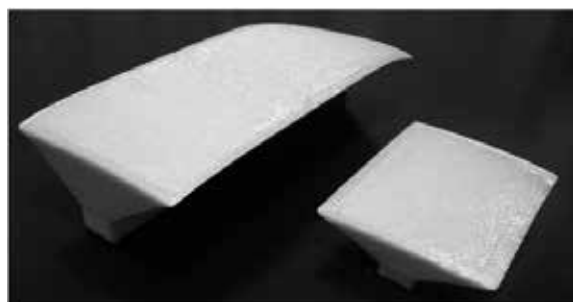
図 9 3D プリンタで印刷した校正用補助具(2)（左は比較のために置いた校正用補助具(1)）
