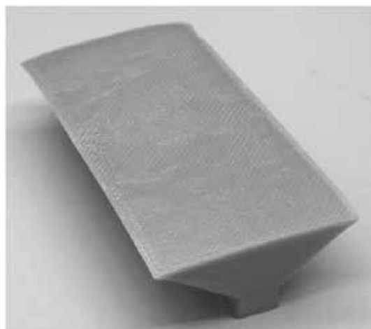
図 4 3D プリンタで印刷した較正用補助具(1)
