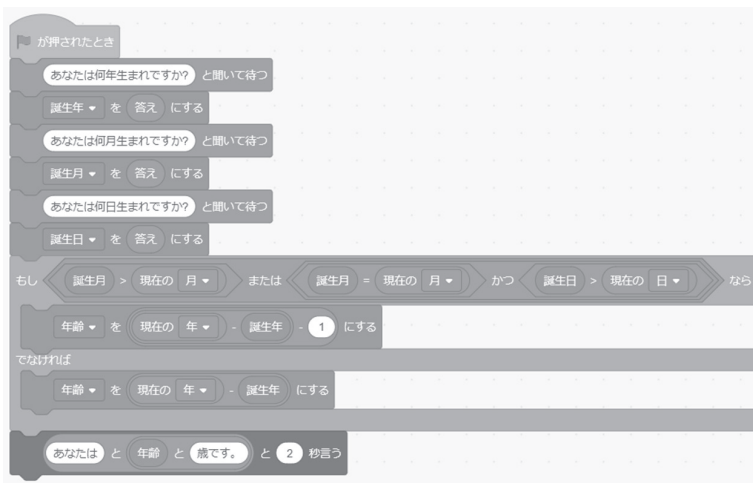
図5 Scratchによる年齢を表示させるプログラム
