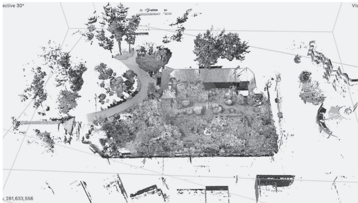
図9 Metashapeにて高密度ポイントクラウドデータの表示
